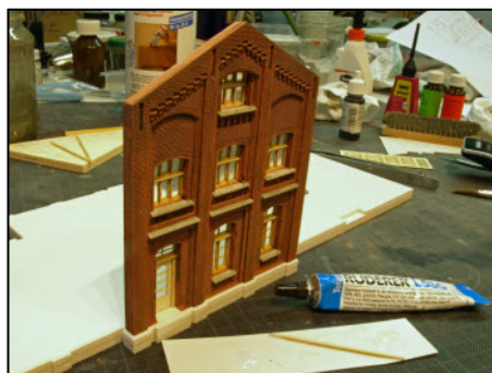
Nun werden die Wände mit Ruderer L530 aufgeklebt. Nehmen Sie sich dafür etwas Zeit und Geduld. Immer erst ohne Klebstoff probeweise positionieren. Unser zweiter Prototyp paßte sehr gut, dennoch müssen kleine Maßdifferenzen zum Beispiel mit ein paar Feilenstrichen teilweise ausgeglichen werden. Die Teile bleiben aber auch mit dem schnellabbindenden Ruderer eine Weile korrigierbar
